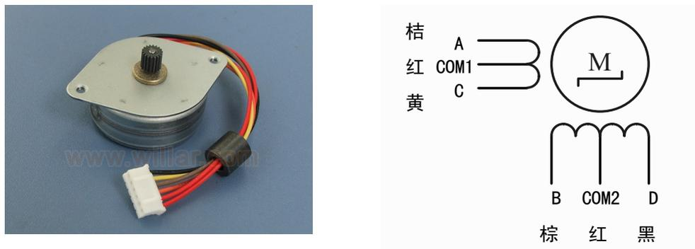
图 6.39 步进电机内部电路
