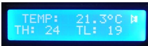
上图中 LCD1602 的第一行显示的小喇叭标志为温度报警时允许蜂鸣器响的标志。
